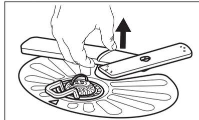
2. Reinigen Sie den Sprüharm unter fließendem Wasser. Entfernen Sie Verunreinigungen aus den Öffnungen des
