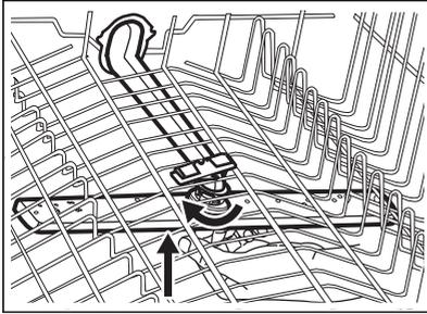
3. Reinigen Sie den Sprüharm unter fließendem Wasser. Entfernen Sie Verunreinigungen aus den Öffnungen des Sprüharms mit einem spitzen Gegenstand, z. B. einem Zahnstocher. Lassen Sie Wasser durch die Austrittsöffnungen laufen, um Verschmutzungen aus dem Inneren zu entfernen.
