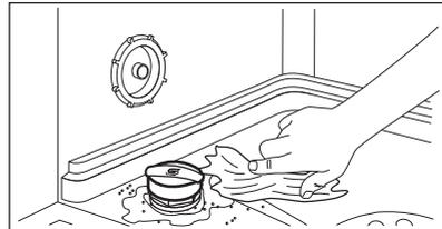
6. Drehen Sie den Deckel des Salzbehälters im Uhrzeigersinn, um ihn zu schließen.
