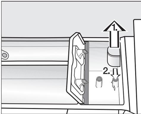
1. Saugheber aus der Kammer
